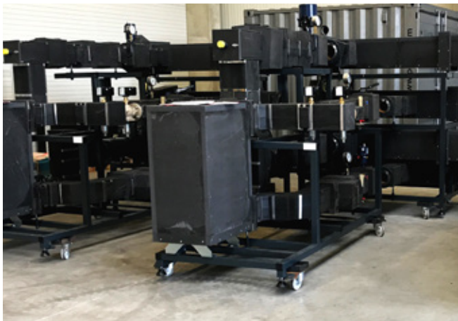
Fertig! Übergabestationen und Verteiler, komplett isoliert
