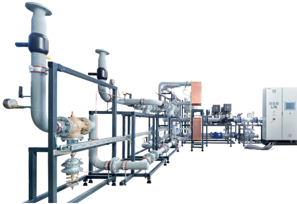
L-förmiger Grundriss: die Fernwärme-Übergabestationen bei der Probemontage
