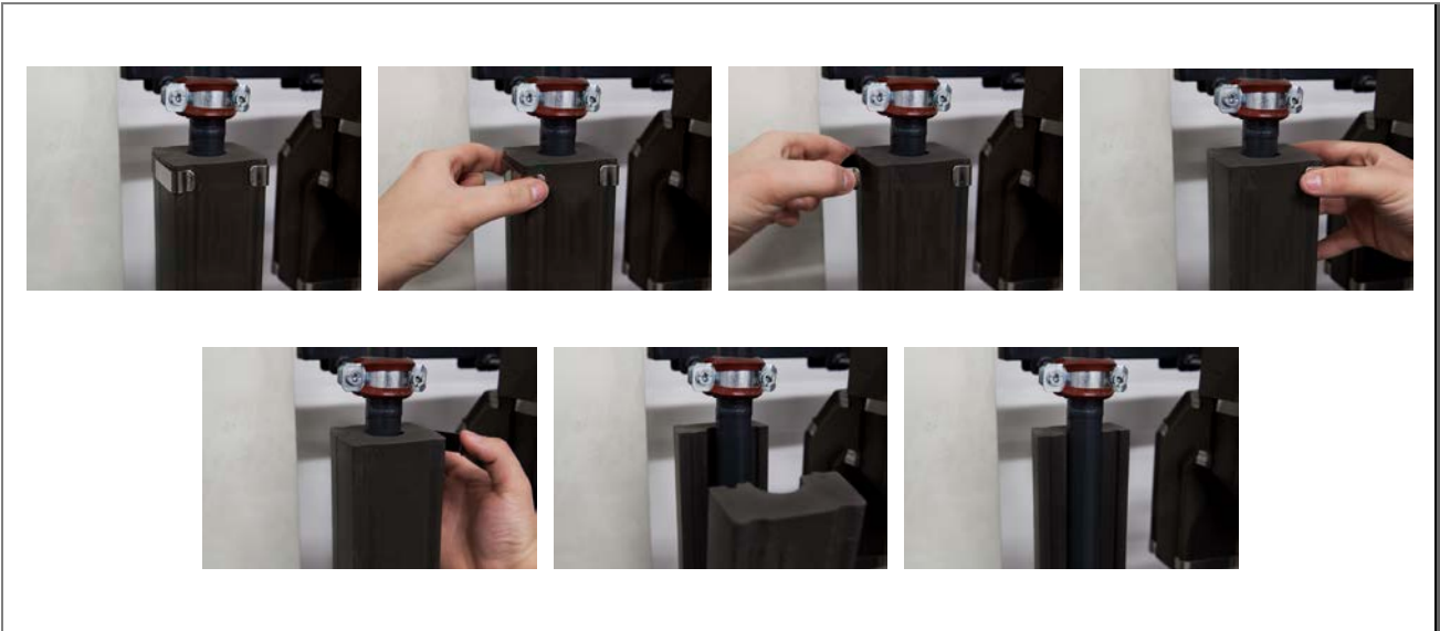
Abb. 2: Abnehmen der pewoPUR Wärmedämmung
