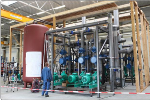
Bildunterschrift: Das künftige Gebäude wurde als Holzständerkonstruktion nachgebaut, um Kollisionen auf allen Ebenen zuverlässig auszuschließen.
